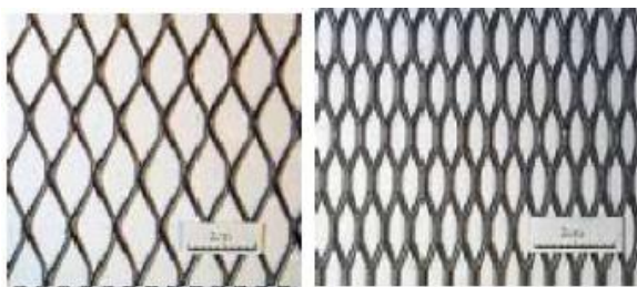
شکل (3): نمونه‌هایی از توری سیمی مورد استفاده جهت بهسازی سطحی دیوار با مصالح بنایی
