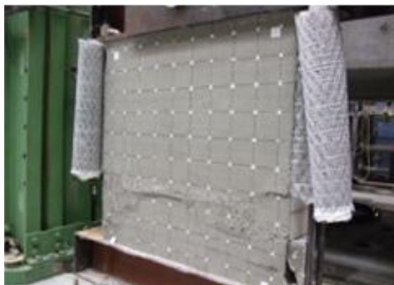
شکل (10): تست آزمایشگاهی بر روی دیوار محصور با پوشش محافظ زلزله
