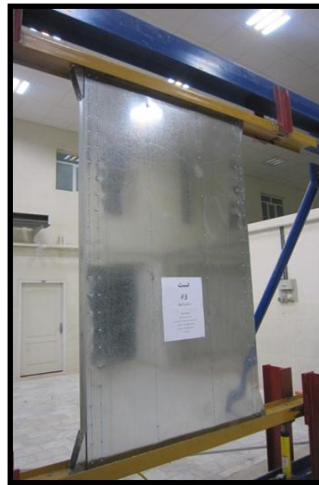
شکل (3): نمای کلی جک های هیدرولیکی و نحوه قرار گیری قاب ها بین جک ها
