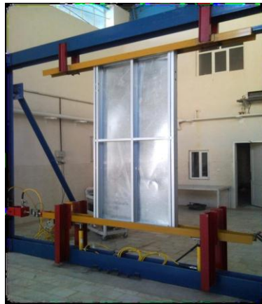
شکل (3): نمای کلی جک های هیدرولیکی و نحوه قرار گیری قاب ها بین جک ها
