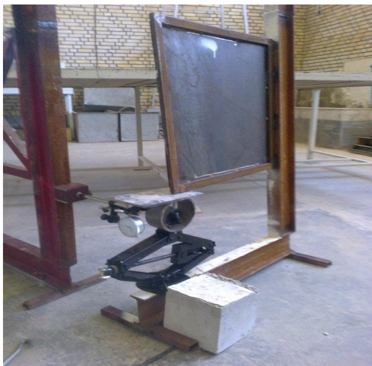
شکل (6): نحوه بارگذاری قاب دارایدیوار برشی فولادی
