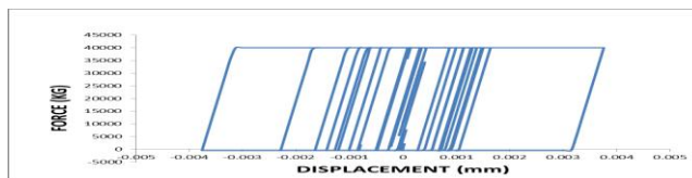
شکل (14): حلقه ی هیستریزیس میراگر IPFD در زلزله کوبه
