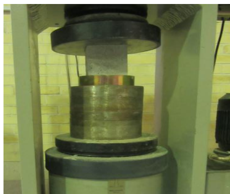
شکل 8- جک هیدرولیکی و نحوه شکستن نمونه‌ها
