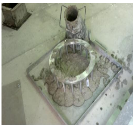
شکل 3- نتایج قطر بتن پخش شده
