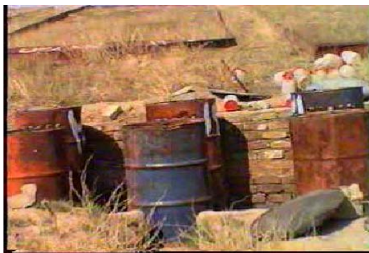
شکل (۲) مخزن اندازه‌گیری رواناب و رسوب
