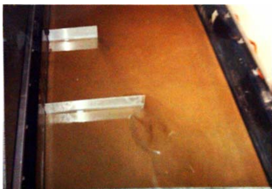
شکل (۴) فلوم آزمایشگاهی آبشکن اصلی و آبشکن فرعی
