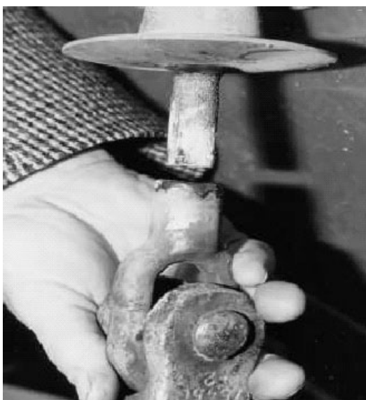
تصویر (۶) : شکست جدایشی مقره کامپوزیتی [۸]
