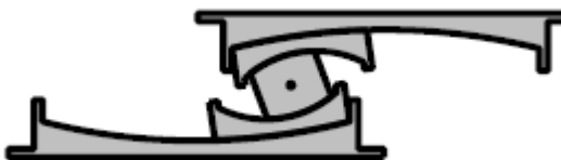
شکل (7): وضعیت جداساز پاندولی اصطکاکی سه قوسی در رژیم های 1 تا 5 به ترتیب از بالا به پایین
