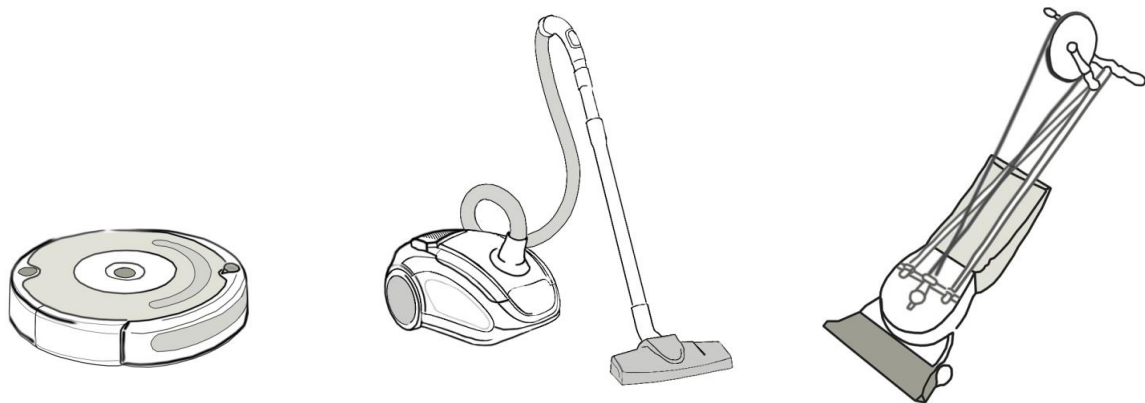
تصویر ۱ از راست به چپ؛ جاروی مکانیکی، جاروی برقی که توسط کاربر هدایت می‌شوند، جاروی هوشمند که بدون نیاز فیزیکی کاربر کار می‌کند (dffn, 2001)
