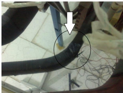
شکل 14: محل بروز تخلیه کامل شیشه S1 در خارج از شیار
