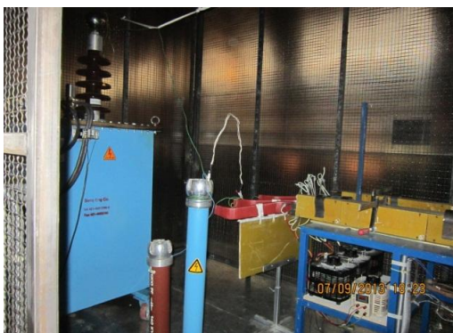
شکل 8: شیشه‌های در حال تست Voltage Endurance
