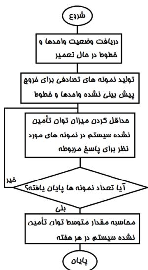
شکل ۲: فلوچارت محاسبه شاخص EPNS
