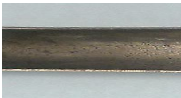
شکل 14: نمای نهایی درون لوله پس از اسید شویی توسط HCl 3% در حضور 0/02 MBT
