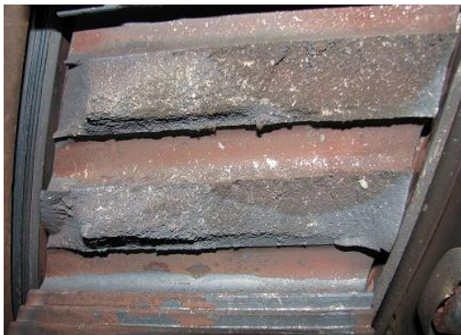
شکل (۳): نمایی نزدیک از محل شکست دیسک ردیف دوم توربین حادثه دیده
