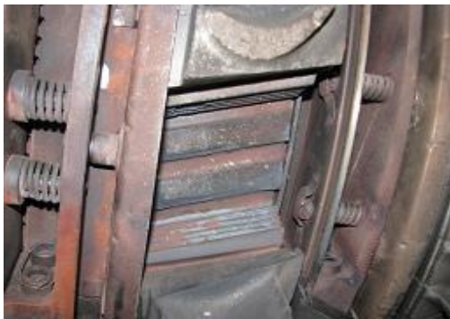
شکل (۲): محل شکست دیسک ردیف دوم توربین حادثه دیده.
