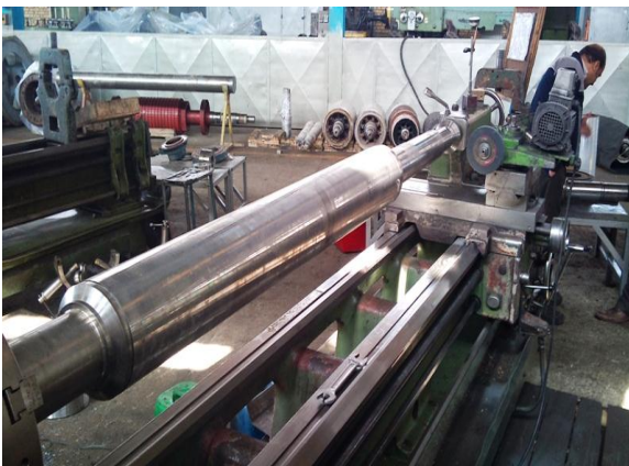
شکل ۶: شافت در حال تراشکاری
