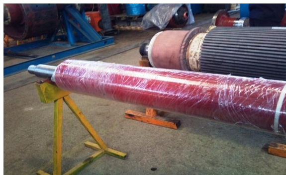
شکل ۸: رتور ساخته شده
