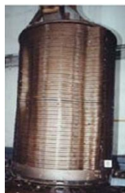
شکل ۱: اثر وارد شدن نیروی شعاعی که باعث غرشدگی سیم پیچ می شود [۷]
