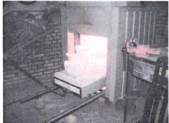
شکل ۱- عملیات پیش گرم قال سرامیکی
