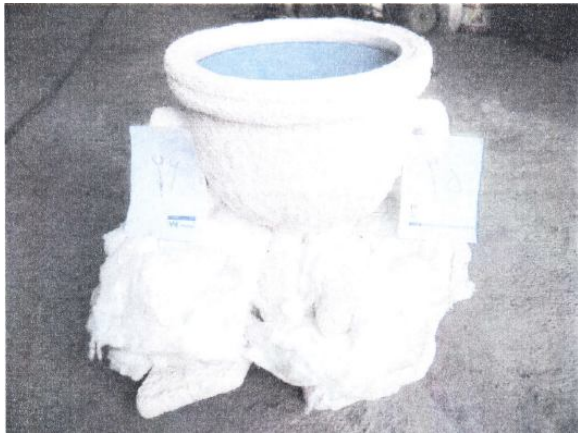
شکل ۳- قالب سرامیکی خوشه ای دوتایی
