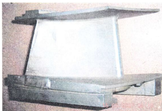
شکل ۴- تصویر نمونه ای از نازل ریخته گری آزمایشی
