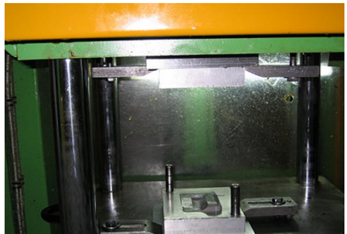
شکل ۱۰- تزریق موم در قالب اپوکسی
