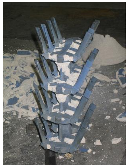
شکل ۱۴- پره های ریخته گری بعد از شکستن پوسته سرامیکی
