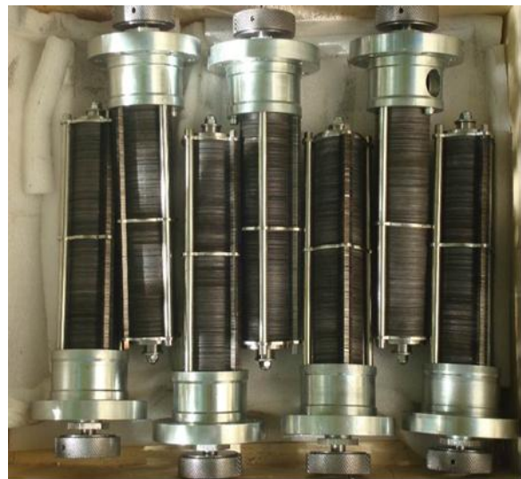
شکل 4: ساخت داخل فیلتر های شانه ای تصفیه مکانیکی مسیر روغن توربین
