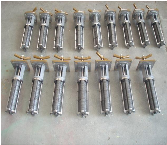
شکل 5: ساخت داخل فیلتر های شانه ای تصفیه مکانیکی مسیر روغن توربین
