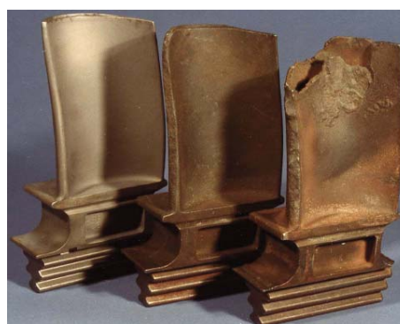
شکل ۱: خوردگی سولفیدی روی پره یک توربین گاز کوچک پس از ۱۰۰۰ ساعت کارکرد با سوختی حاوی 2ppm سدیم [۱۱]
