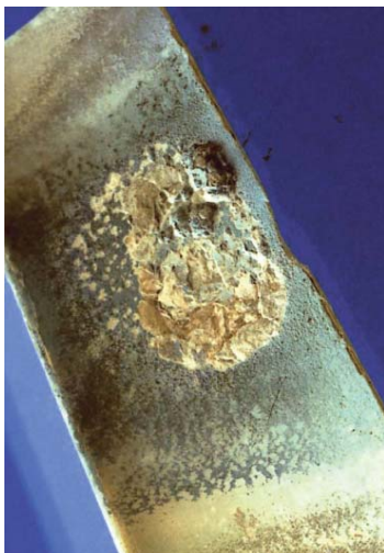
شکل ۲: اثر وانادیم و اکسید شدن شتابنده سطح پره توربین [۱۲]
