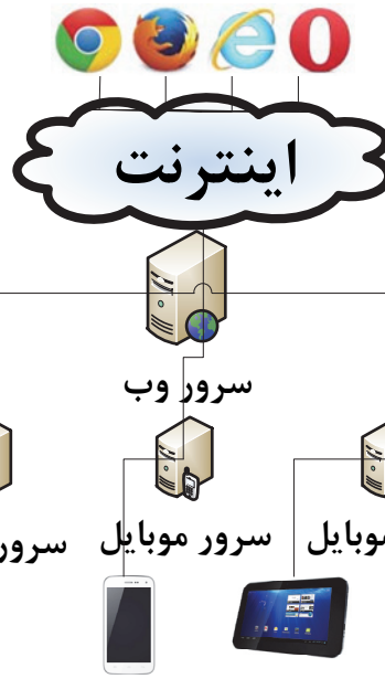
شکل (۱) معماری ارتباطی محیط ابری آزمایش نرم افزار تلفن همراه
