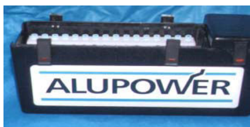
شکل ۲- یک نمونه پیل سوختی آلومینیوم-هوا ۲/۸۵ کیلو وات ساعت جهت حمل توسط سرباز
