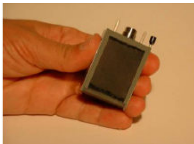
شکل ۳ - یک نمونه پیل سوختی آلومینیم-هوا طراحی شده برای تلفن همراه [
