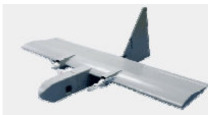
شکل ۱- شمایی از پرنده (UAV) و سیستم پیل سوختی روی - هوای جاسازی شده در بال آن
