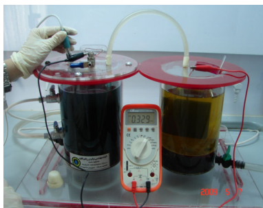
شکل ۱- تصویر راکتور MFC دو محفظه‌ای مورد مطالعه
