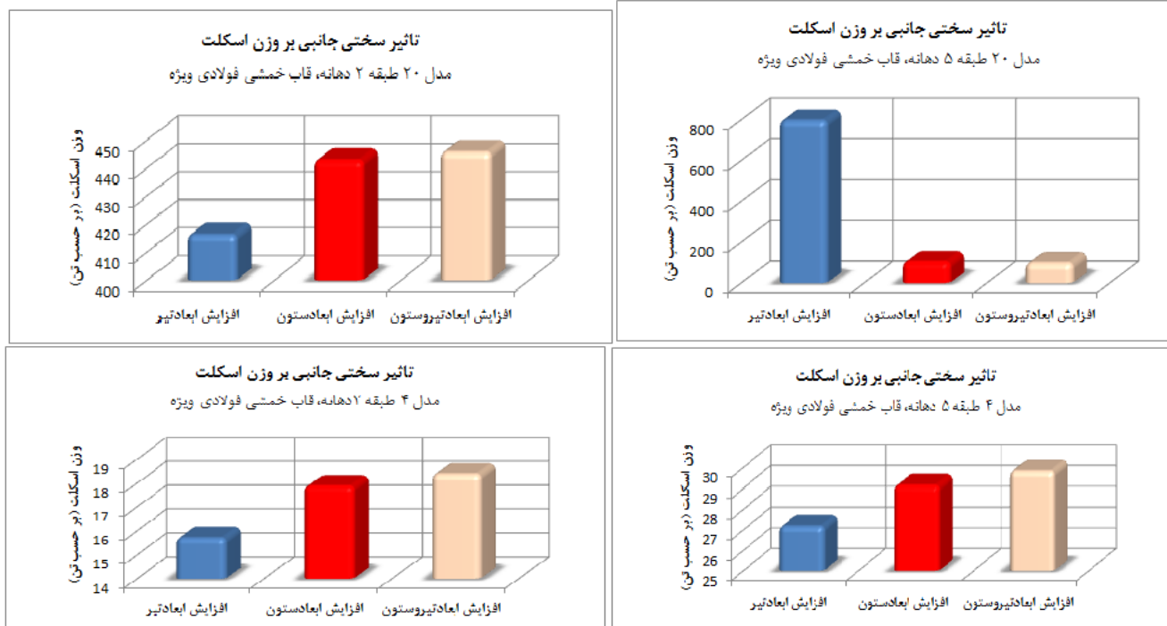
شکل ۷- وزن اسکلت سازه فولادی
