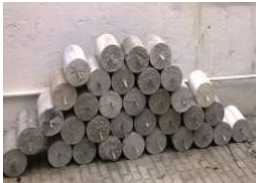
شکل ۴ - نمونه های تست بیرون کشیدگی در تحقیق
