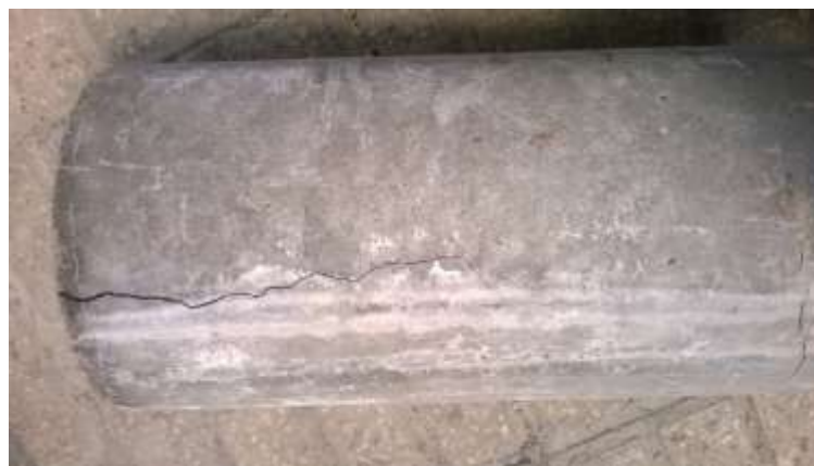
شکل ۶- نمونه تست بیرون کشیدگی GFRP
