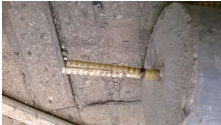
شکل ۵- نمونه تست بیرون کشیدگی میلگرد GFRP
