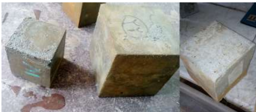
شکل ۶: الف) ترک ناشی از ۶۰ چرخه یخبندان بر روی نمونه fc-900-60. ب) پوسته شدن سطح روی نمونه‌های fc1000-120، fc900-120، fc1100-120
