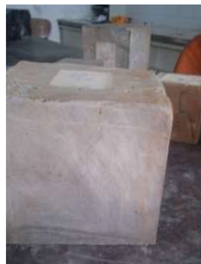
شکل ۶: الف) ترک ناشی از ۶۰ چرخه یخبندان بر روی نمونه fc-900-60. ب) پوسته شدن سطح روی نمونه‌های fc1000-120، fc900-120، fc1100-120
