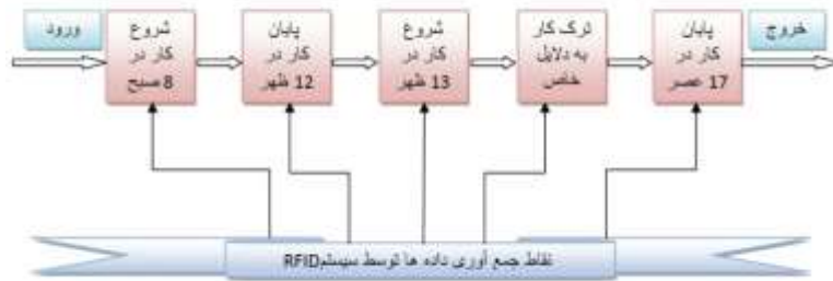
شکل شماره ۵ نحوه محاسبه زمان کار افراد توسط سیستم RFID
