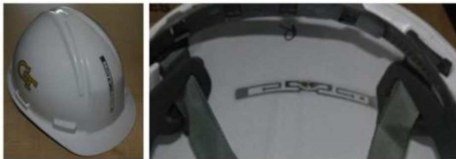
شکل شماره ۶ تگ RFID نصب شده بر روی کلاه ایمنی کارگران
