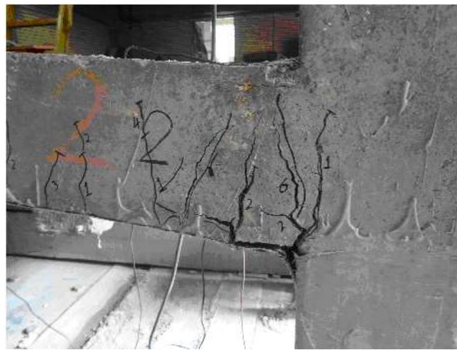
شکل ۴: خرابی تیر BS2 در اثر جداسدگی CFRP از روی تیر و پارگی GFRP دور پیچ
