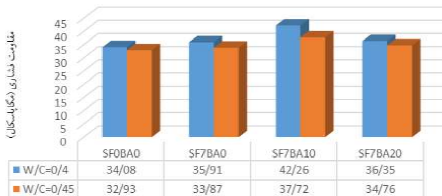
نمودار ۳: مقاومت فشاری کسب شده در سن ۹۰ روزه برای نسبت‌های مختلف آب به مواد سیمانی
