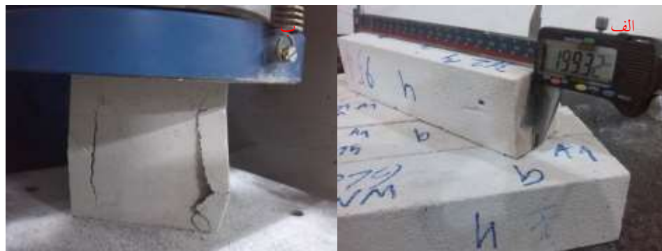
شکل ۳- (الف) نحوه بارگذاری فشاری تا گسیختگی، (ب) نحوه اندازه‌گیری کرنش همکشیدگی
