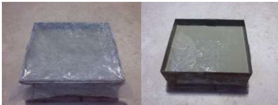
شکل ۲- مخلوط فوم بتن الیافی در قالب و نحوه قرار گیری پوشش محافظ
