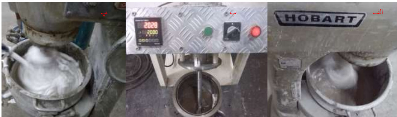
شکل ۱- (الف) جداسازی الیاف با دستگاه پراکنده‌ساز، (ب) مخلوط کردن الیاف با دیگر ترکیبات، (پ) مخلوط کردن فوم با ماتریس سیمان و الیاف
