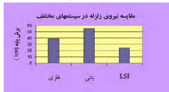
شکل ۱۵- برش پایه ساختمان در سیستم های مختلف [۹]
