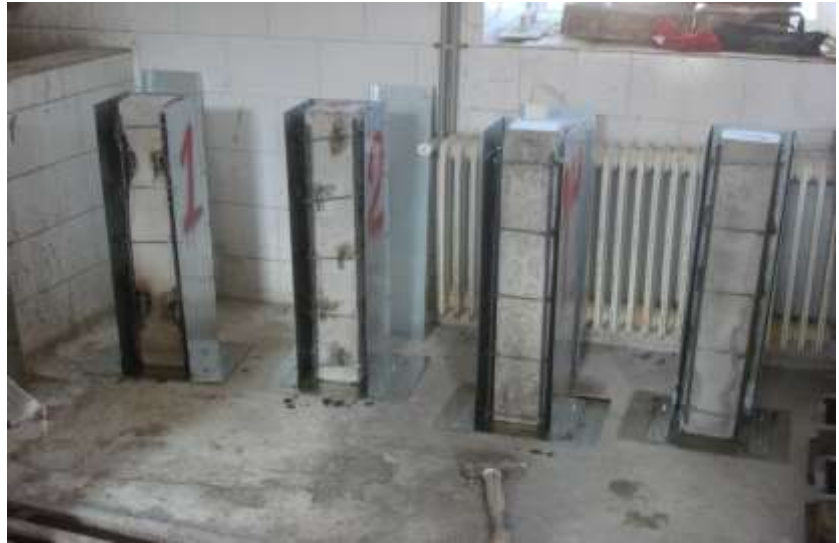
شکل ۱. نمونه های ساخته شده ستون بتنی تقویت شده با روکش بتنی
