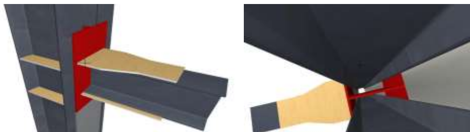
شکل ۶: نما بالا و کنار اتصال صلب تیر به ستون دویل با ورق میانی
