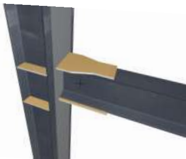
شکل ۷: نمای کنار اتصال صلب تیر به ستون دویل با ورق پوششی
