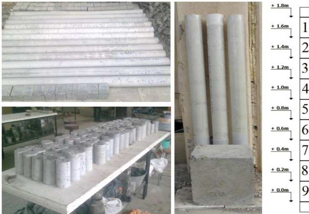
شکل ۲: قالب بندی، قرارگیری ستونها و نمونه ها در هوای آزاد، برش ستونها به نمونه های استوانه ای استاندارد، نحوه نامگذاری نمونه ها در ارتفاع ستون
