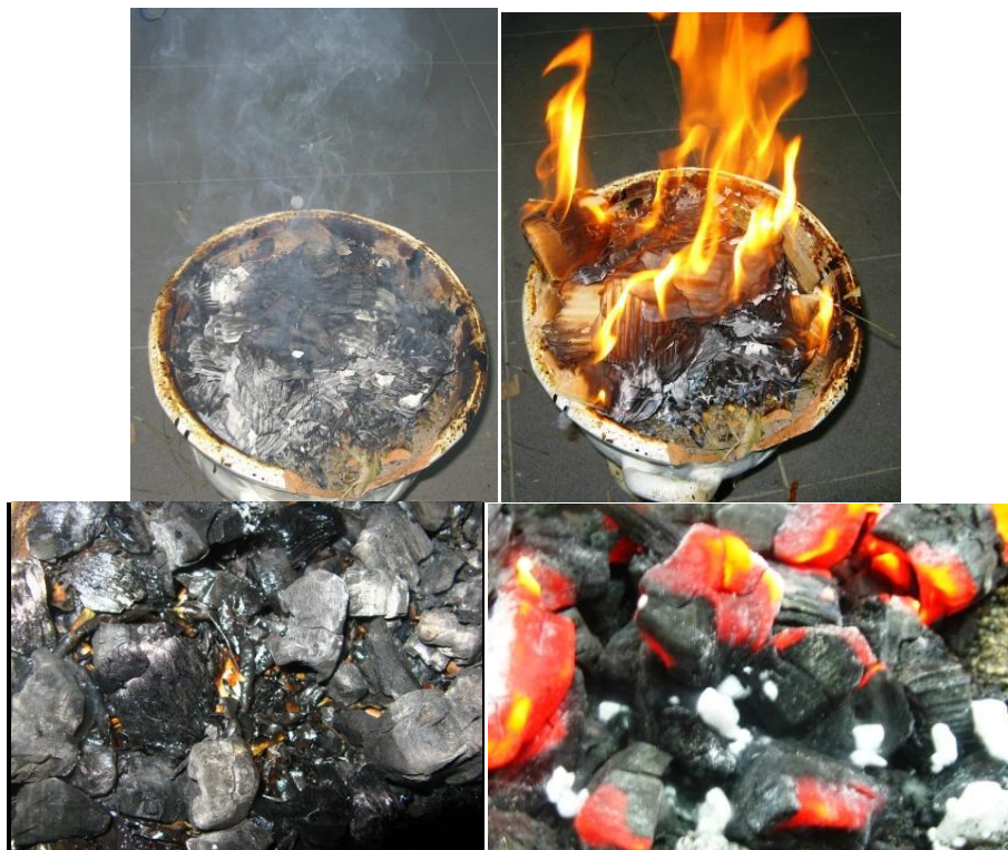
شکل ۶. خاموش کردن آتش با استفاده از هیدرات دی اکسید کربن و آب
