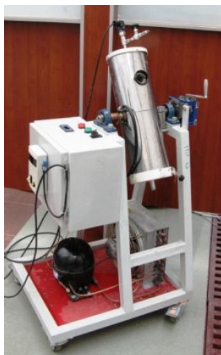
شکل ۴. دستگاه تشکیل هیدرات (طراحی و ساخت در پژوهشکده نفت و گاز سهند)
