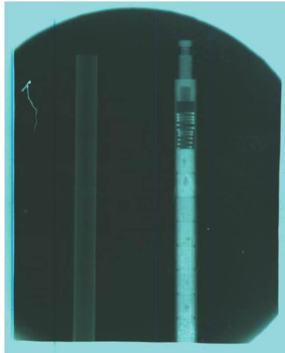
شکل ۴ تصویر میله سوخت مجازی حاصل از رادیوگرافی نوترونی
