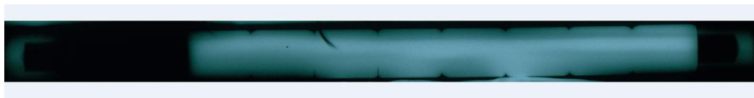
شکل ۳ تصویر رادیوگرافی اشعه ایکس از میله سوخت مجازی
