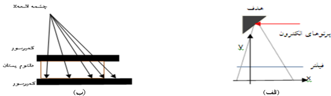
شکل ۱. الف) نمایشی دو بعدی از هندسه شبیه سازی شده تیوپ اشعه X (ب) شرایط پستان در دستگاه ماموگرافی.
