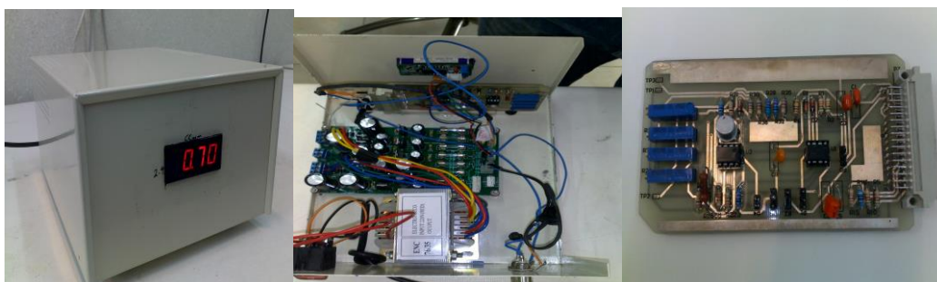
شکل ۲- نمایی از الکترونیک کانال ایمنی ، سیستم تغذیه \pm 15 ولت و کیس مورد نظر ساخته شده
