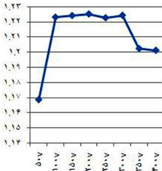
نمودار ۱- تعیین ولتاژ کاری آشکار ساز
