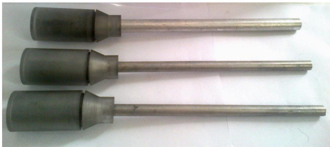
(شکل ۲) سه نمونه آشکارساز اتاقک یونش ۳۰cc ساخته شده
