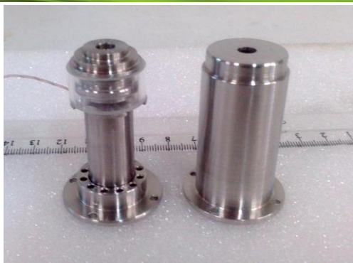
شکل ۱: چشمه یونی پیننگ ساخته شده؛ سمت راست: هندسه مدل شده و سمت چپ: اجزاء چشمه ساخته شده
