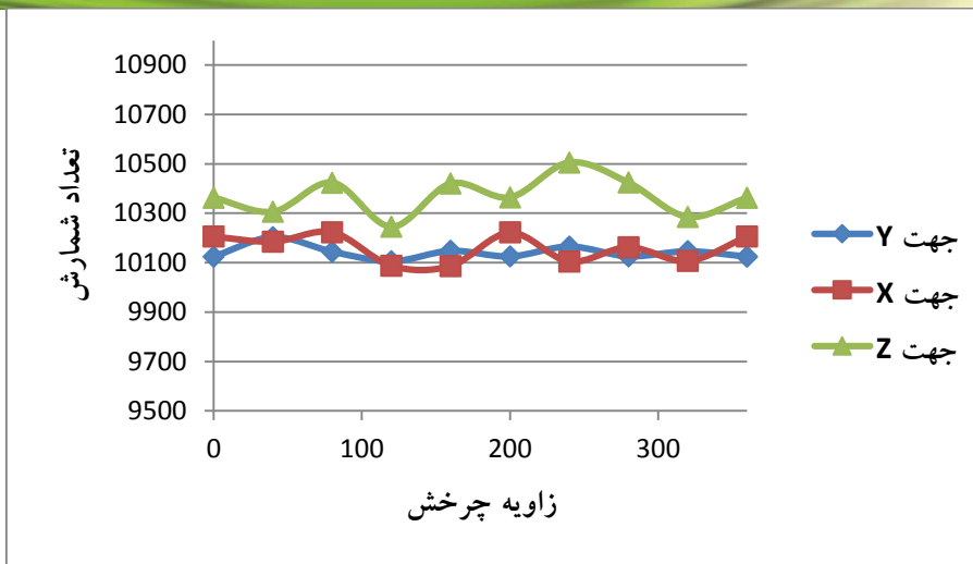
شکل ۴. نتایج مربوط به PMT استفاده شده با حفاظ مغناطیسی
