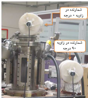
شکل ۲: شمارنده‌های فعالسازی نقره در زوایای ۰ و ۹۰ درجه نسبت به سر آند
