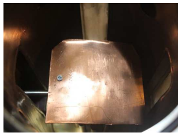
شکل (۱). شاتر مسی مورد استفاده در دستگاه SBUMTPF1
