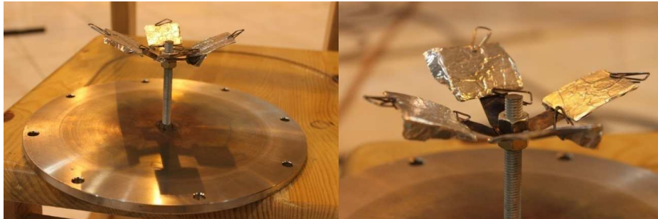
شکل (۳). نحوه قرار گرفتن پلی‌کربنات روی نگهدارنده
