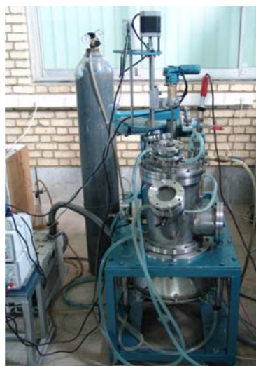
شکل (۱)- دستگاه رشد بلور
