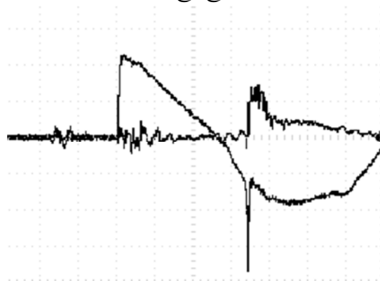
شکل شماره (۴). نمونه ای از سیگنال ثبت شده از جریان تخلیه و فنجان فارادی در فشار 0.8 \text{ mbar} و ولتاژ اعمالی 23 \text{ kV} .
