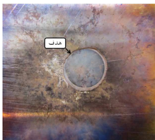
شکل ۴: هدف دوتریومی که در پشت ورق آلومینیومی در مکان بیشترین چگالی یونی چسبانده شده است
