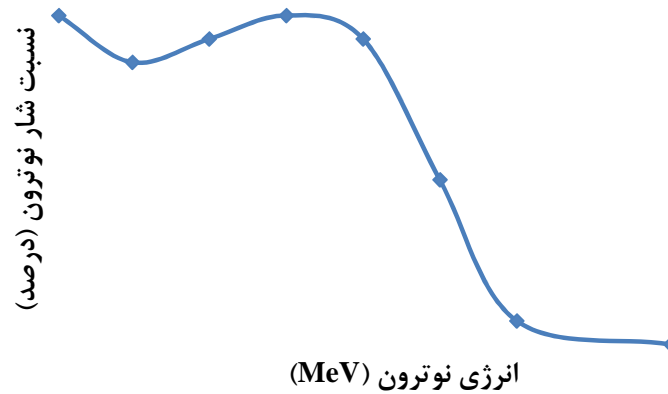
شکل (۳): نمودار طیف انرژی نوترون تولید شده از برخورد پروتون (۱۷ MeV) با هدف لیتیومی.
