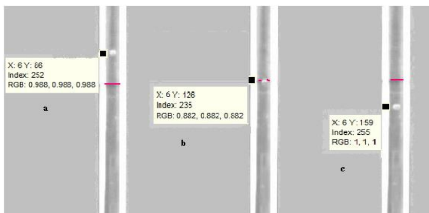
شکل (۳): سه فریم نمونه از سقوط قطره، (a) قبل از عبور از شاخص، (b) در حال عبور از شاخص و (c) بعد از عبور از شاخص
