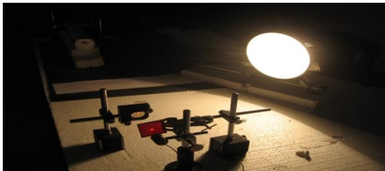
شکل ۳-ب: برپایی ساختار تجربی تحریک ماده دز خورده برای تغییر ضریب جذب آن.
